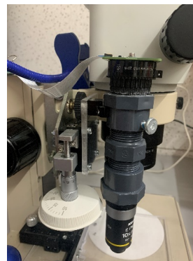
Figura 5: Cámara-objetivo en montaje paralelo a lupa.
