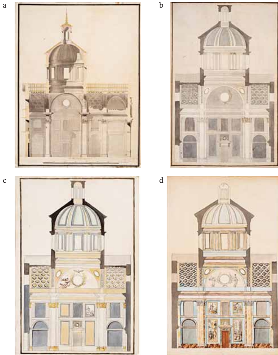
fig. 62.- S. Á. de Ochandátegui, Capilla de San Fermín. Planos de reforma. 1797: a.- Sección longitudinal / b.- Sección transversal / c.- Proyecto decorativo / d.- Proyecto decorativo.
