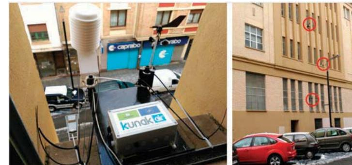
Figura 6. Medidas de concentración de contaminantes atmosféricos y parámetros meteorológicos a diferentes alturas en una calle con efecto cañón en Pamplona como parte de las actividades del proyecto LIFE+RESPIRA.
