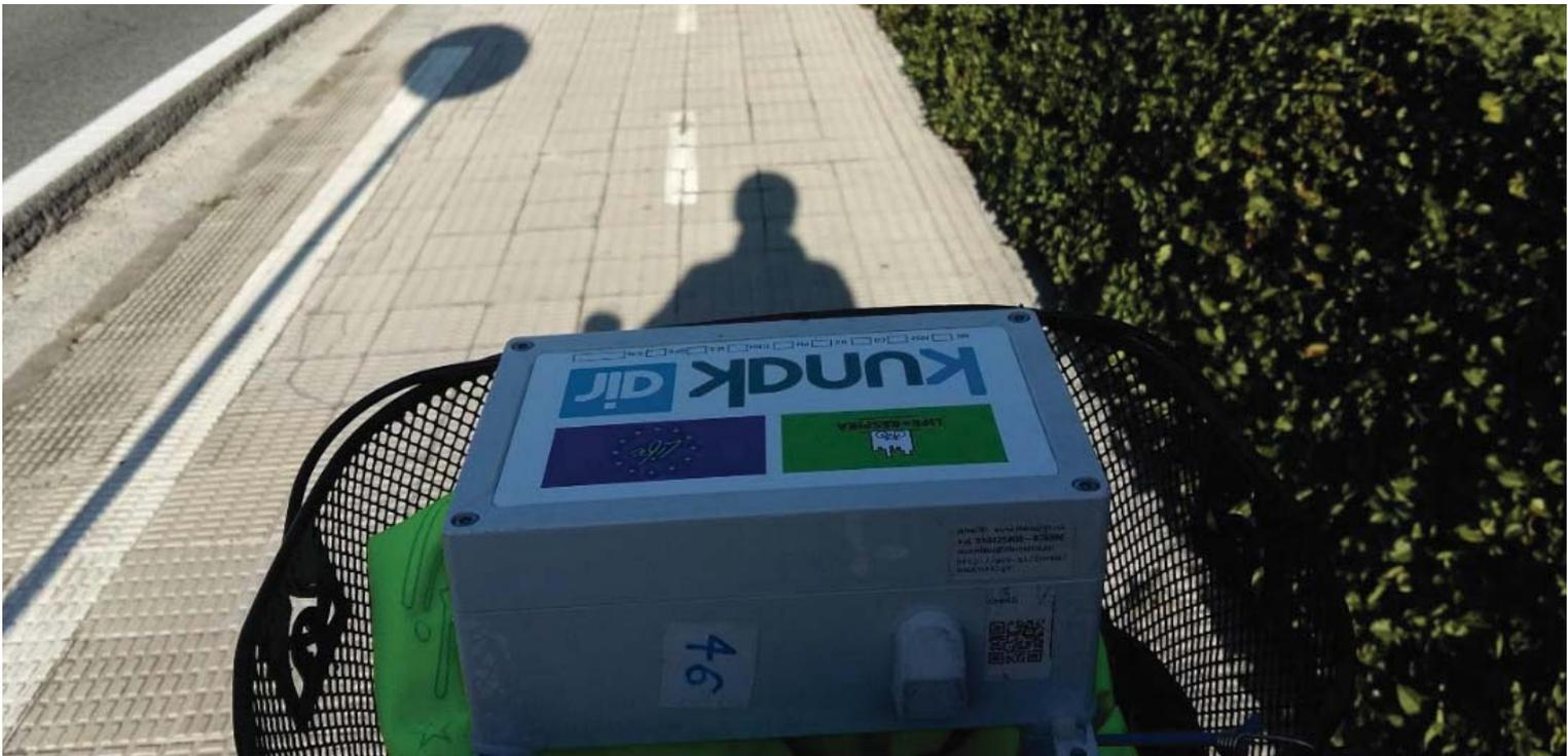
Figura 1. Analizador en posición típica en la cesta de una bicicleta, circulando por un carril bici.
