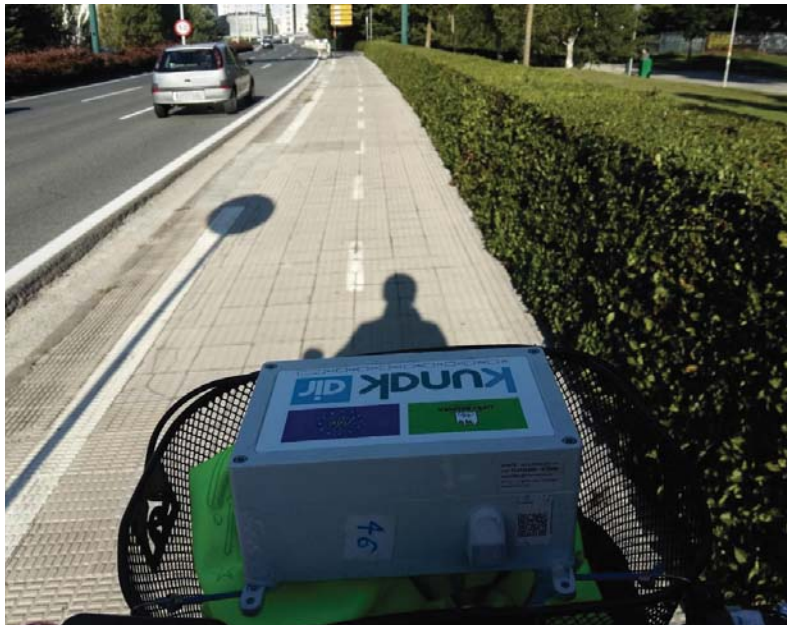
Analizador en posición típica en la cesta de una bicicleta, circulando por un carril bici
